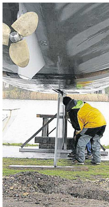
Moment délicat : la mise en place de la dérive, qui pèse 1,2 t.
